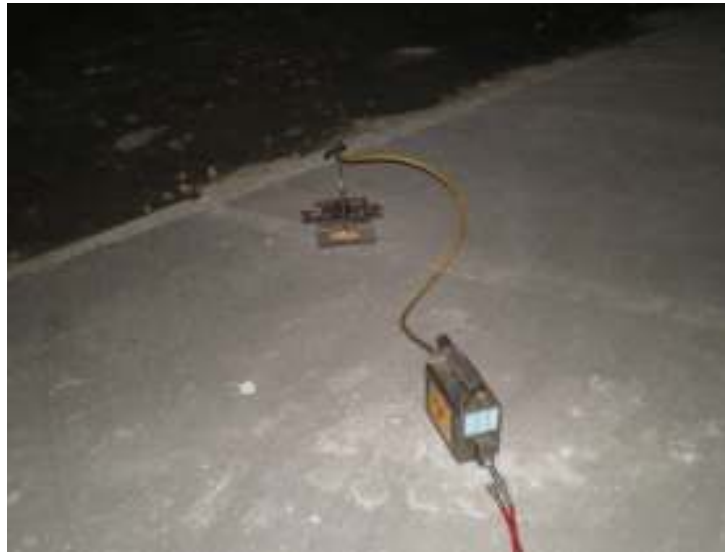
圖三 伽瑪射線檢測銲工銲道試片
