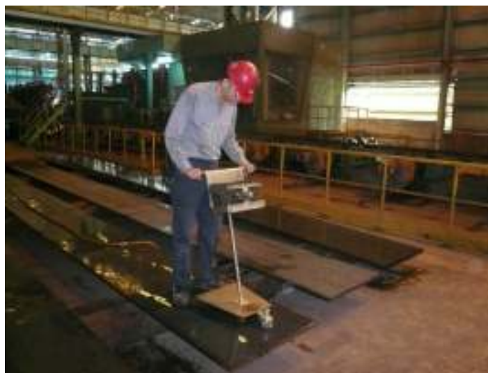
圖五 直束探頭檢測鋼版
