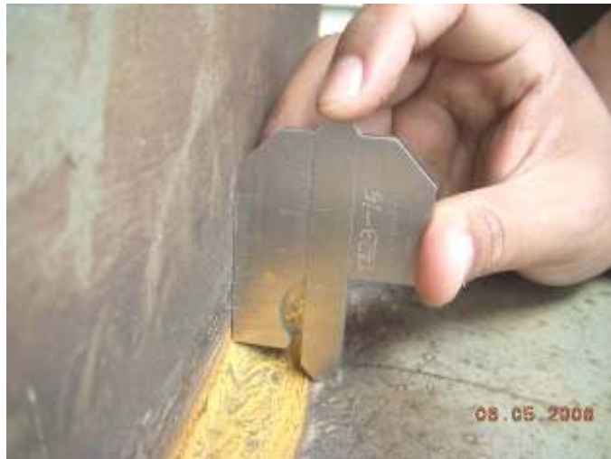
圖二 鐸道規測量鐸道腳長
