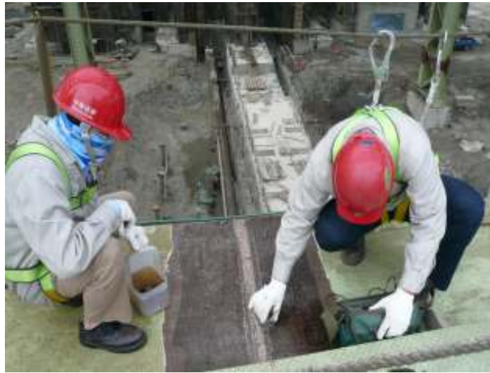
圖六 斜束探頭檢測銲道
